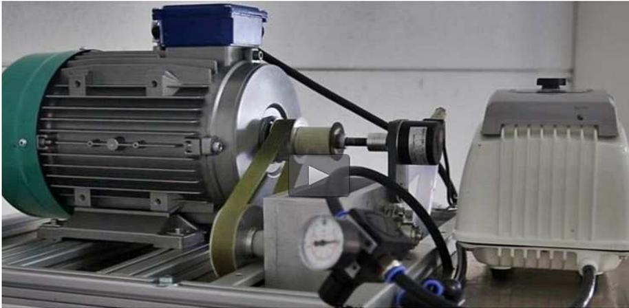
Nahaufnahme von Generator mit Dreh-Encoder zur Drehzahlmessung, Getriebe und Kompressor, die auf der Abschlussplatte der Auftriebsröhre angebracht sind (siehe Bild auf der ersten Seite). Auf dem Video beim Abspielen erkennt man klar die Druckschwankungen am Manometer, verursacht durch die Arbeit der Ventiltechnik des Kraftwerks (Momentaufnahme von der Website [gaia-energy.org](http://gaia-energy.org)).
