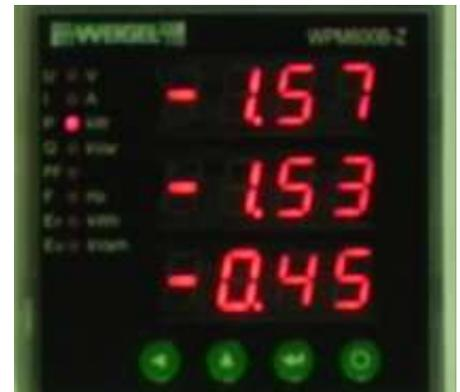
Bei Lastwechsel wurde die betreffende Phase um  $1,58 \text{ kW} - 0,45 \text{ kW} = 1,13 \text{ kW}$  entlastet.
